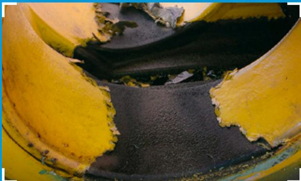
Die Verdunstungsfläche der Impfdüse minimiert sich und der Odorstoff kann nicht mehr vollständig verdampfen. Die Impfdüse verliert mit der Zeit ihre Funktion und kann im Extremfall durch den Einfluss von Strömung und Vibrationen abreißen.
